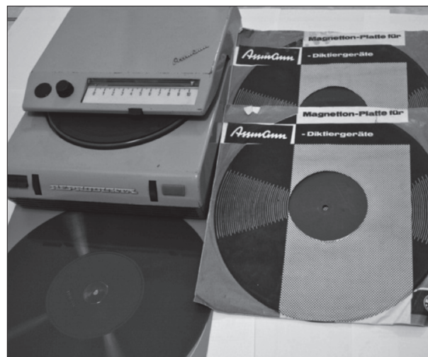
Ein Magnetplatten-Aufnahmegerät aus den 60er Jahren
